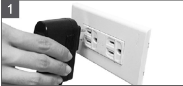
เสียบ AC Adapter เข้ากับเต้าเสียบ
